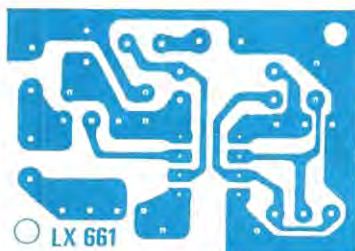
Fig. 3 Disegno a grandezza naturale del circuito stampato.
