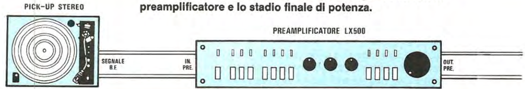
Fig. 27 L'equalizzatore andrà inserito sempre tra lo stadio preamplificatore e lo stadio finale di potenza.
